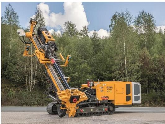
(3) 2022 präsentierte Klemm das weltweit erste batterie-elektrohydraulische Ankerbohrgerät für Überlagerungsbohrungen KR 806-3E.
